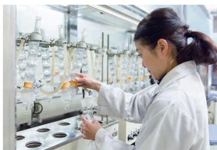
脂肪抽出装置。サンプル中の脂肪分の量を測定するために抽出する装置
