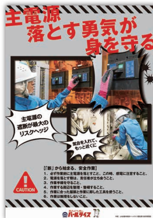
▲機械清掃・点検時の電源OFF徹底
