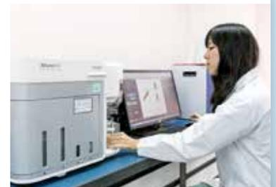
細胞浮遊液を高速で流すフローサイトメーターで、免疫細胞の形状や性質を解析
