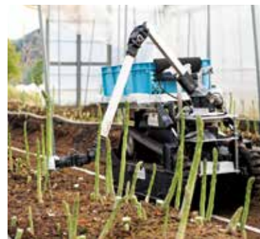
inaho(株)のアスパラガス収穫ロボット
