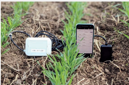
土壌(水分量・温度・塩類濃度・Ph)と空気(気温・湿度・CO 2 濃度)と日照量のデータを取得できる「Agri Palette」のセンサー
