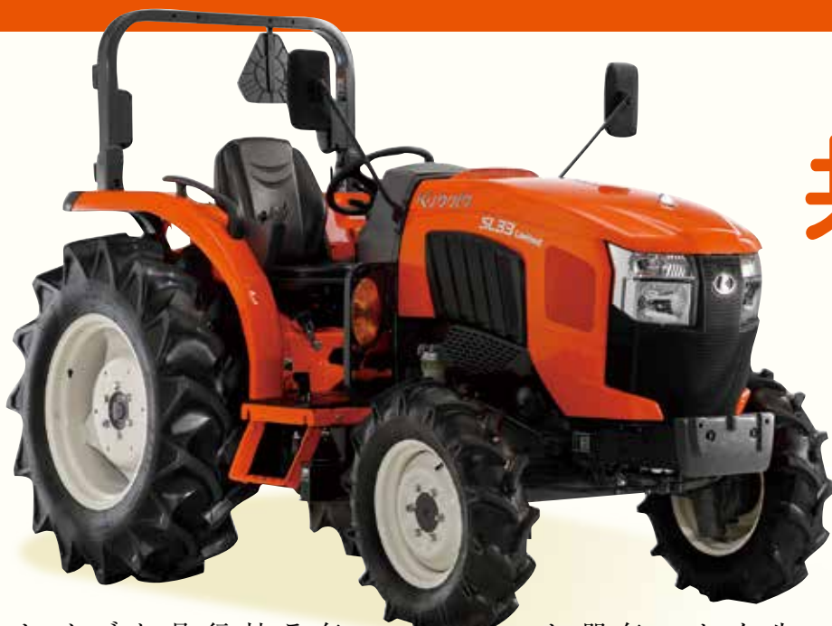
SL33LFMAEP (クボタ) (安全フレーム・標準速・ホイル仕様)
