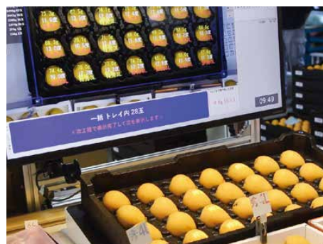
ビワ出荷に威力を発揮するスマート選果システム
