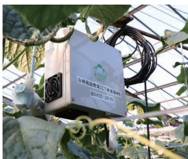
ハウスに設置した環境モニタリング機器「あぐりログ」
