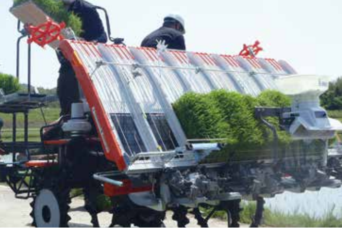
GPSを搭載した自動運転田植機による有機米の田植え
