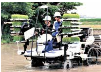
田植機が自動で施肥を行う側条可変施肥の実演
