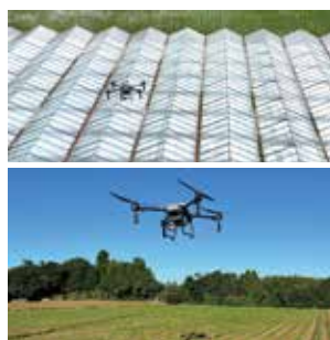
(上) ドローンによる施設(ハウス)への遮光・遮熱資材の塗布作業は、今後さらなる活用が期待されます (下) ニンジン圃場における高温対策に係わる葉面散布
