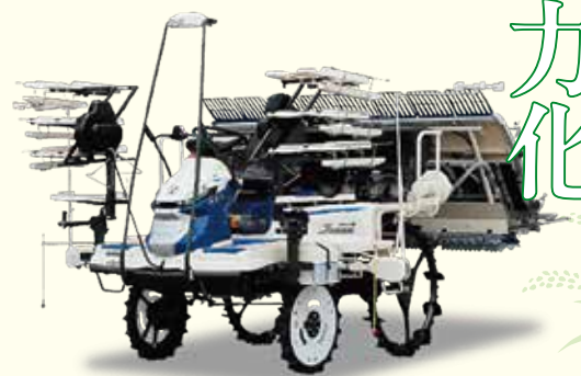
圃場試験で使用した乗用田植機 (井関農機(株)PRJ8シリーズD型FS仕様)
